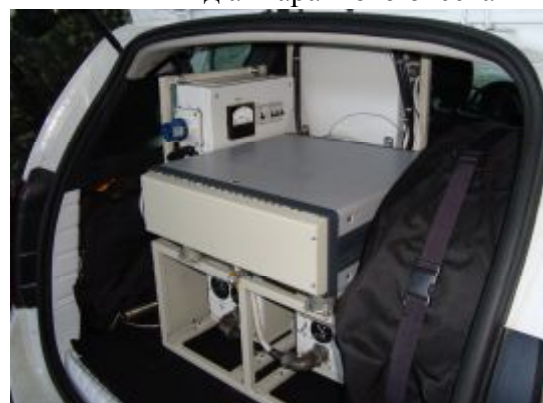
Мобильный радиопеленгатор «Беркут» на базе джипа Reno «Duster»: внешний вид
