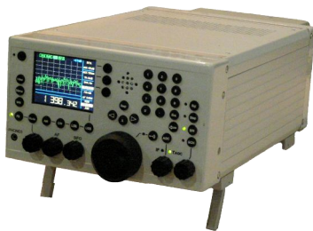
Радиоприемное устройство (изделие «Галактика-М»)
