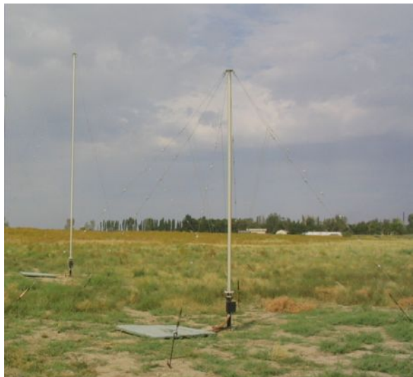
Внешний вид штыревых антенных элементов пеленгаторной АФС изделия “Восток-РП1”
