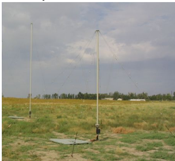
Внешний вид штыревых антенных элементов пеленгаторной АФС изделия “Восток-РП”
