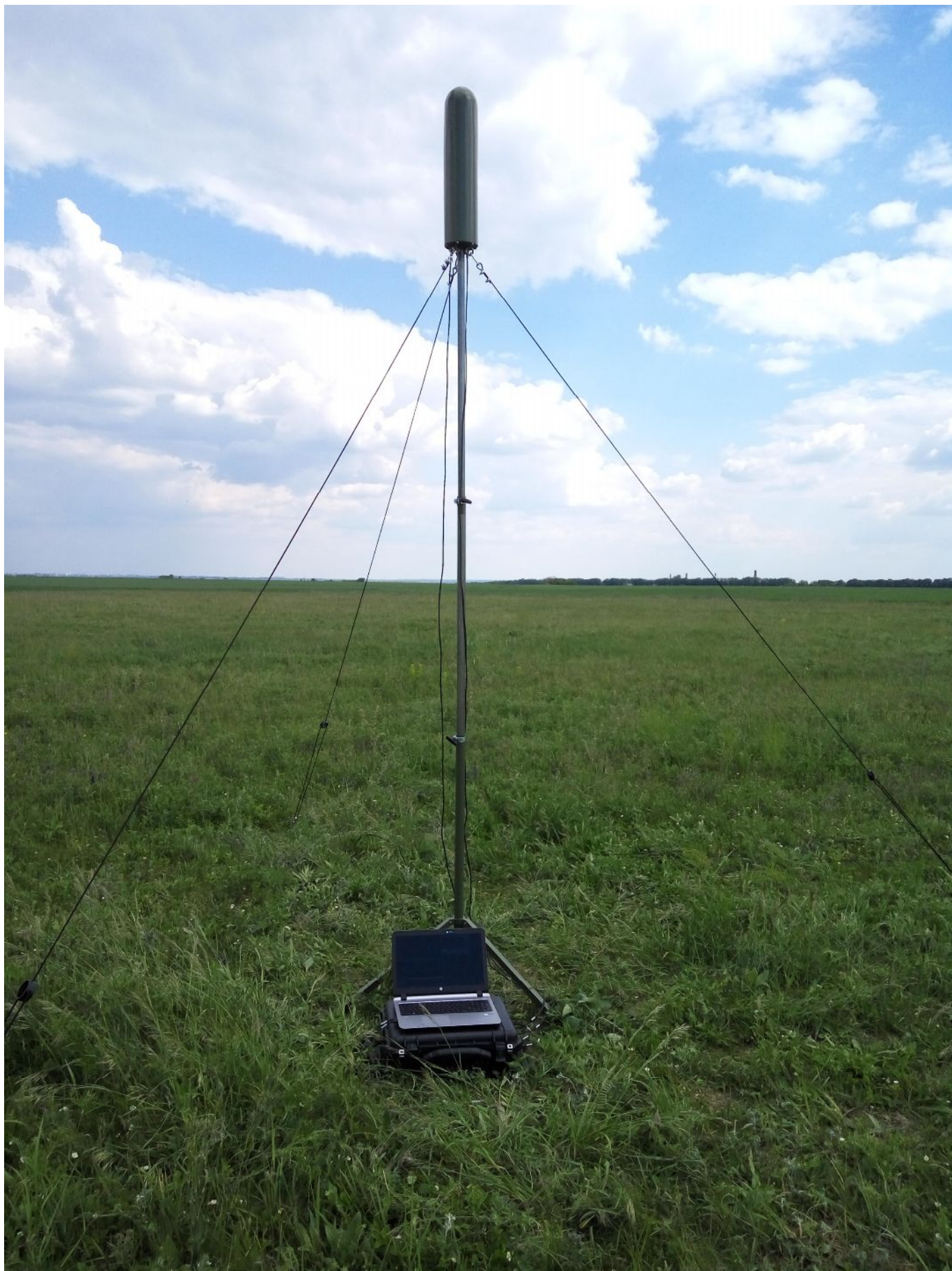
Изделие «Панорама-Ф» в кейсе с активным диполем и дискоконусной антенной в одном радиопрозрачном обтекателе (АФС-НП) при полевом развертывании
