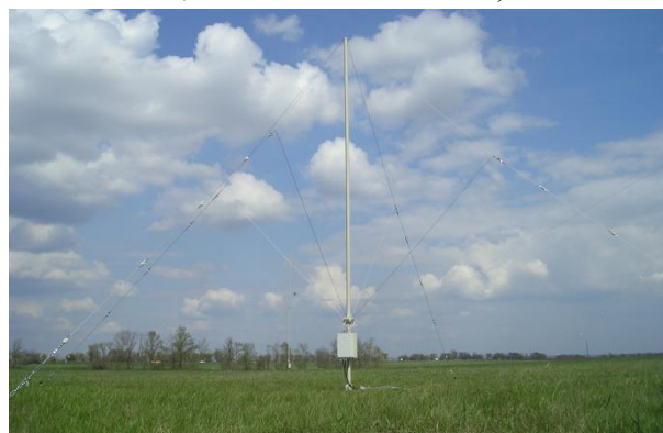
Зовнішній вигляд рамкових антенних елементів пеленгаторних АФС виробу "Восток-РП" (II піддіапазон частот)
