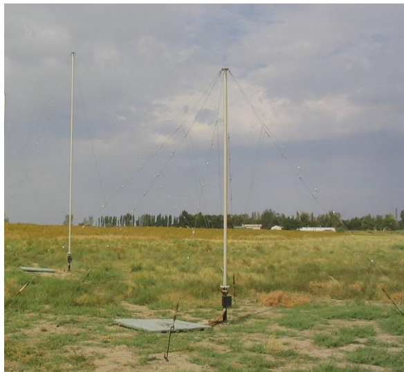
Зовнішній вигляд штирьових антенних елементів пеленгаторних АФС виробу "Восток-РП"
